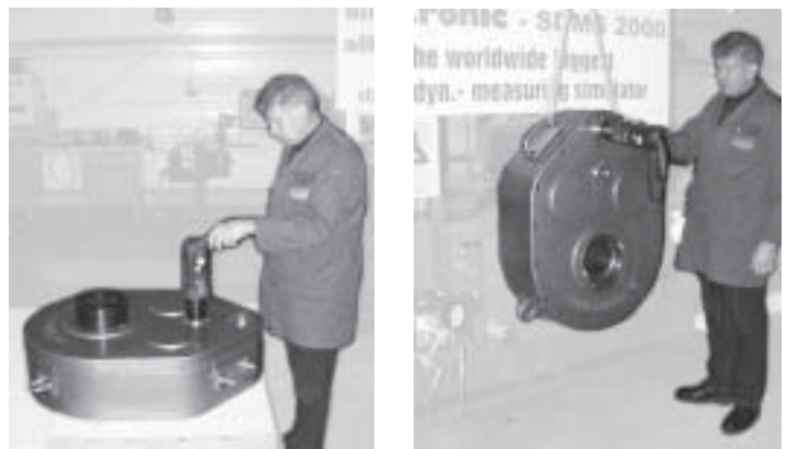
Mechanischer Getriebetest und Vorbereitung für die Messdatenerfassung auf dem Prüfstand
