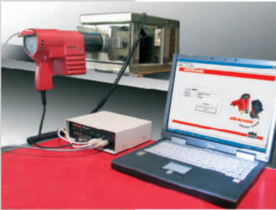
Calibra 2020 Anlagenbeispiel, Drehmomentmessung an einem alkitronic-EFC Schrauber
